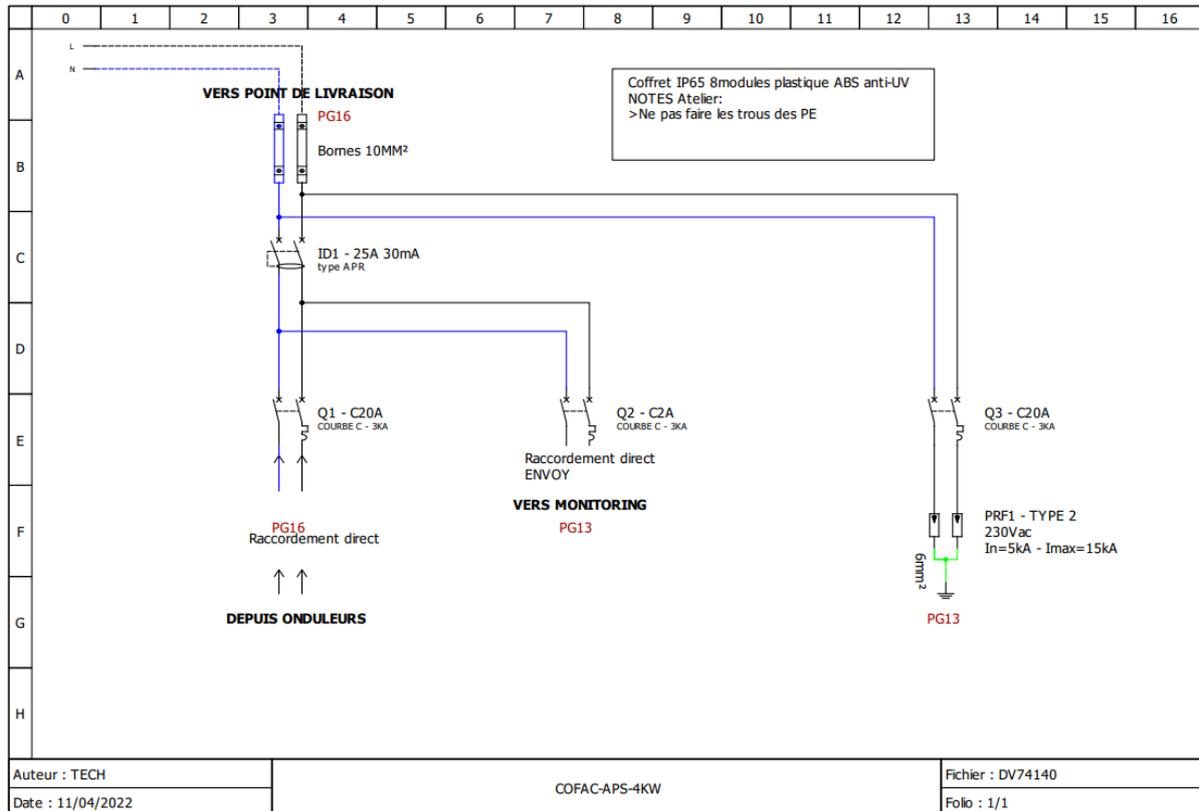
Selon les modèles disponibles chez nos fournisseurs, le coffret peut soit avoir une prise pour le branchement de la passerelle de communication, soit un presse étoupe pour raccorder la passerelle directement au disjoncteur de protection.
